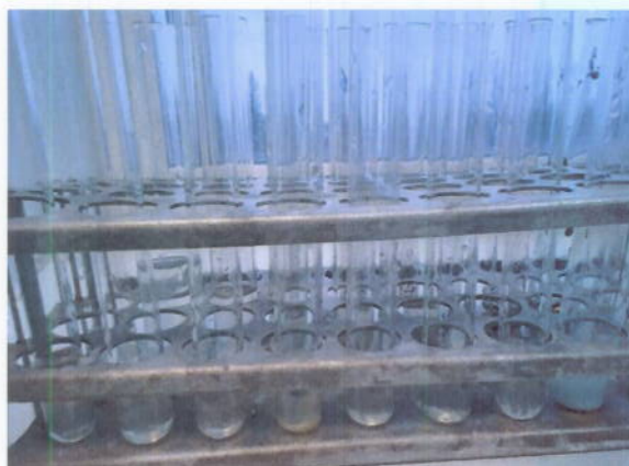
Рис. 10. Постановка качественных реакций на ионы солей: А – реактивы; Б – проба на сульфат-ионы (справа – контроль с \text{Cu}_2\text{SO}_4 ); В – проба на сульфит-ионы (справа – контроль цвета бихромата с дистиллированной водой)
