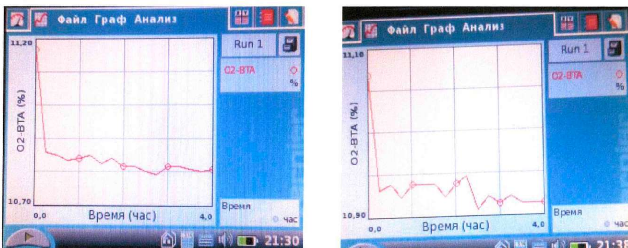
Рис. 5. Графики, демонстрирующие поглощение кислорода при дыхании растения в темном шкафу
