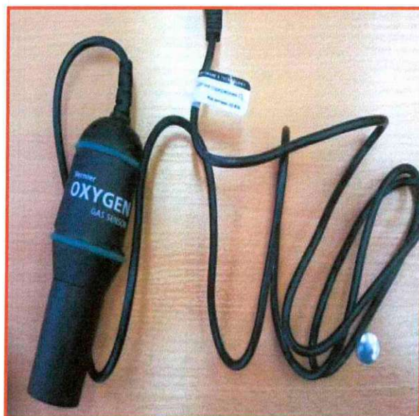
Фото 2. Датчик содержания кислорода
