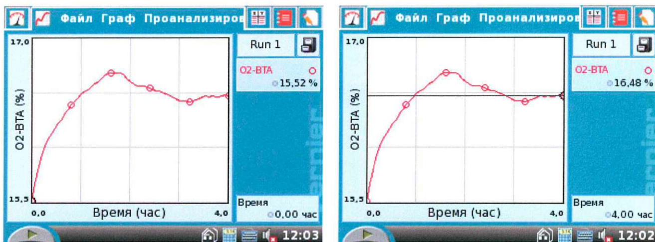
Рис. 4. Графики, демонстрирующие изменения в выделении кислорода при освещении настольной лампой без светофильтров
