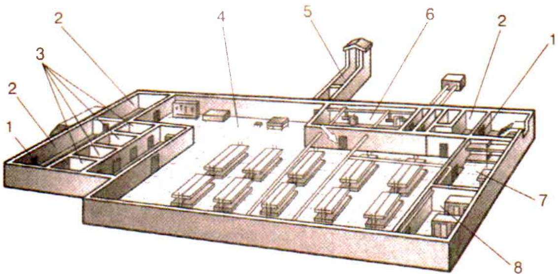
Тип защитного сооружения - Бункер —
