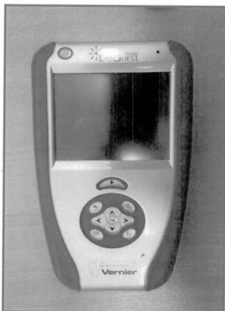
Фото 3. УИОД - устройство измерения и обработки данных LabQuest
