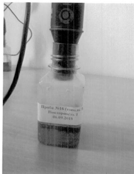
Фото 4. Подключение датчика, определение количества кислорода в пробе
